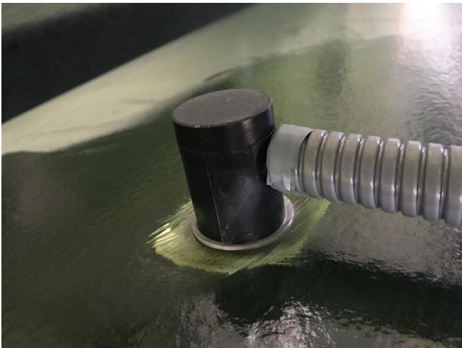
Bild: Fest installierte Schallemissionssensor
